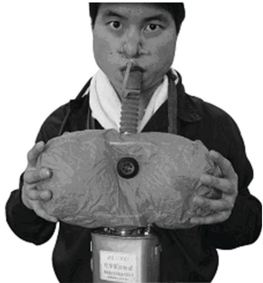
7. 调整挎带 如果挎带过长,抬不起头,可以拉动挎带上的大圆环,使挎带缩短,长度适宜后,系在小圆环上。
