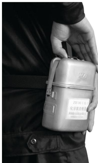
2. 开启扳手 使用时先将自救器沿腰带转到右侧腹前，左手托底，右手下拉护罩胶片，使护罩挂钩脱离壳体扔掉再用右手掰锁口带扳手至封印条断开后，丢开锁口带。
