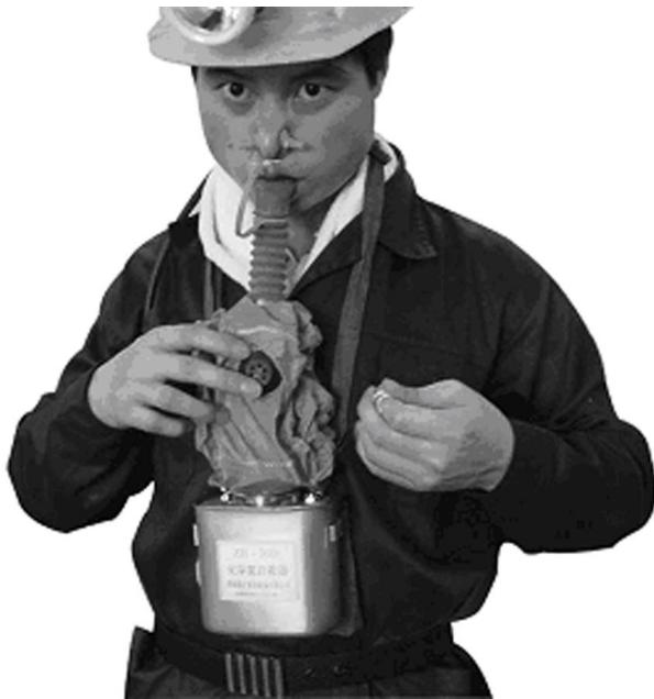
5. 拔出启动针，自救器启动，气囊逐渐膨起；若启动失效，立即拔掉口具塞，将口具塞入口中，口具片置于唇齿之间，牙齿紧咬牙垫，迅速向自救器深呼气，自救器照样工作。
