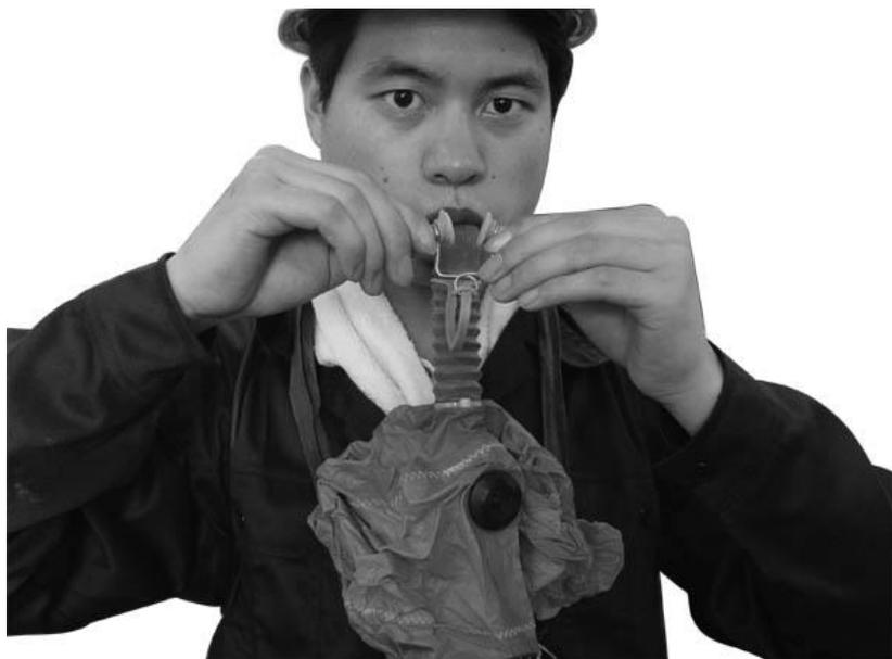
6. 夹好鼻夹 两手同时抓住两个鼻夹垫的圆柱形把柄，将弹簧拉开，憋住一口气，使鼻夹垫准确地夹住鼻子。
