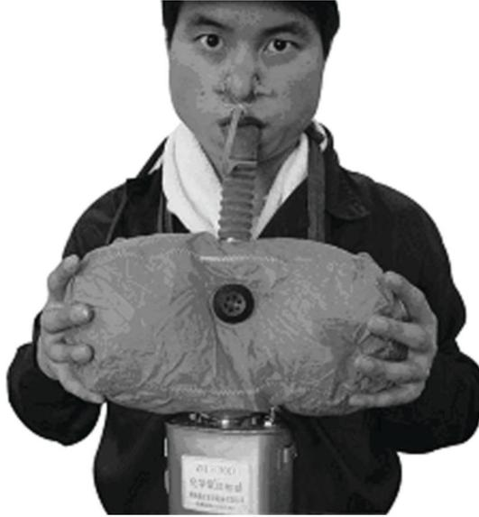
7. 调整挎带 如果挎带过长,抬不起头,可以拉动挎带上的大圆环,使挎带缩短,长度适宜后,系在小圆环上。
