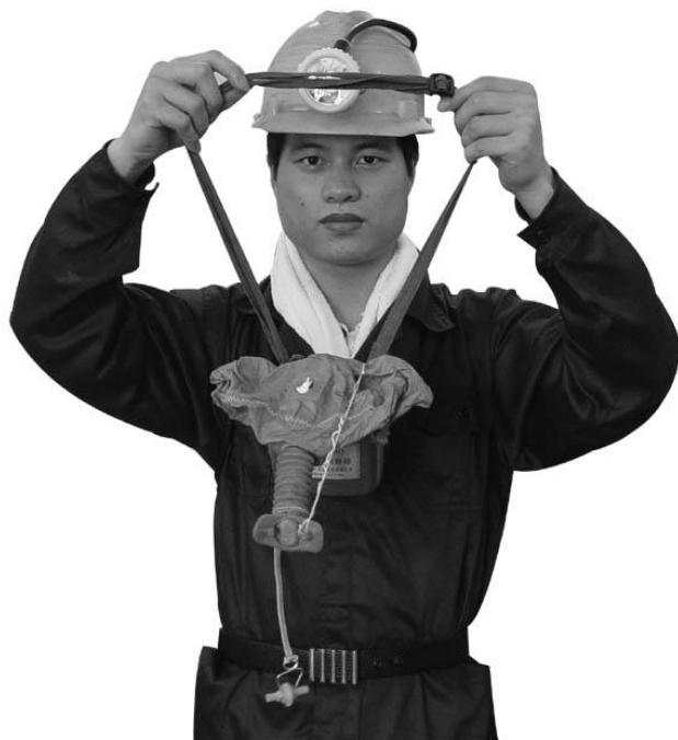
4. 套上挎带 将挎带组套在脖子上，然后将气囊及呼气软管整理至自然舒展状态。
