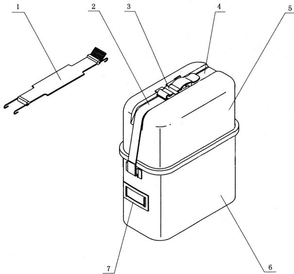
图1 取下保护带（罩）的自救器外部结构图
