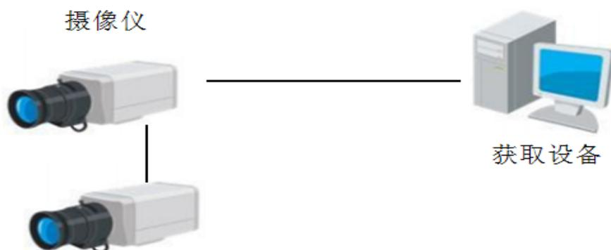
摄像仪直接连接到视频获取设备：如（硬件录像机、视频服务器、电脑）
