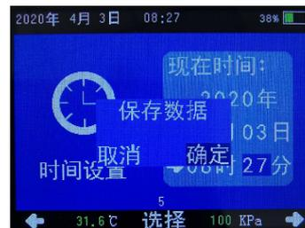
进入时间调整界面后，按动“+”“-”键进行调整时间数值，按动 OK 键切换时间单位（年月日时分），当光标切换至分钟单位后，再按动 OK 键保存数据或取消，期间无操作等待 10 秒后自动取消，返回气体检测界面。
